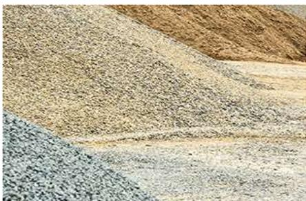
Gli **inerti** sono composti di sabbia e ghiaietto estratti dalle cave di rocce alluvionali o compatte. Circa il 60% degli inerti è utilizzato nella costruzione di strade, il resto viene impiegato nella produzione del calcestruzzo.
